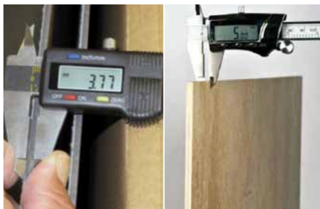
Ejemplo de un panel/losa de loseta de porcelana calibrada de 3,5 mm (3.5 mm) de espesor con malla de refuerzo
