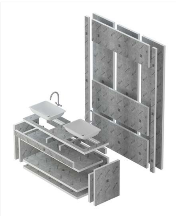
Erstellen einer Waschtischeinfassung und Verkleidung
