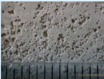
Bild 5: Oberfläche thermischer Anhydrit
