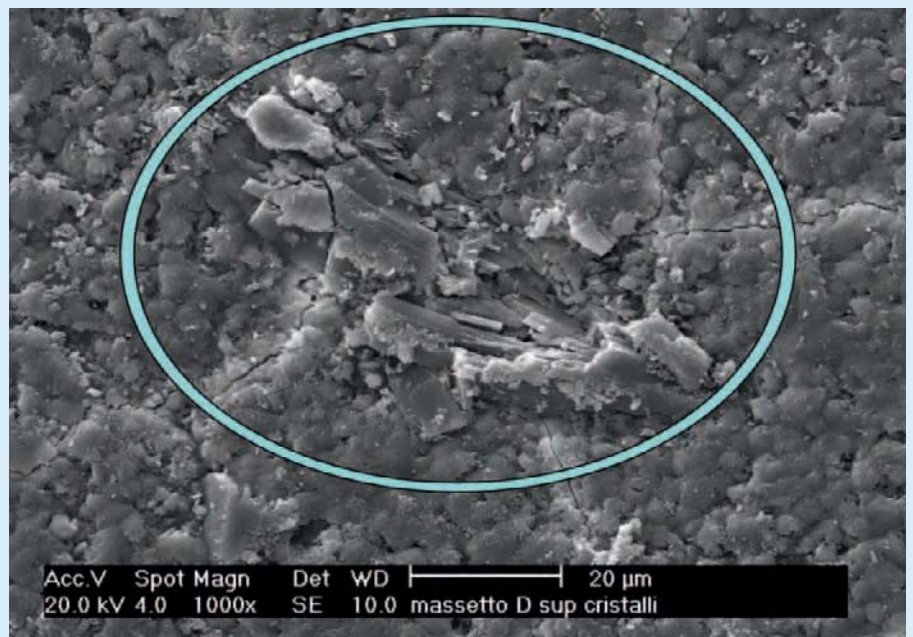
Bild 7: Rasterelektronenmikroskopaufnahme der Naturanhydritfließestrichoberfläche
