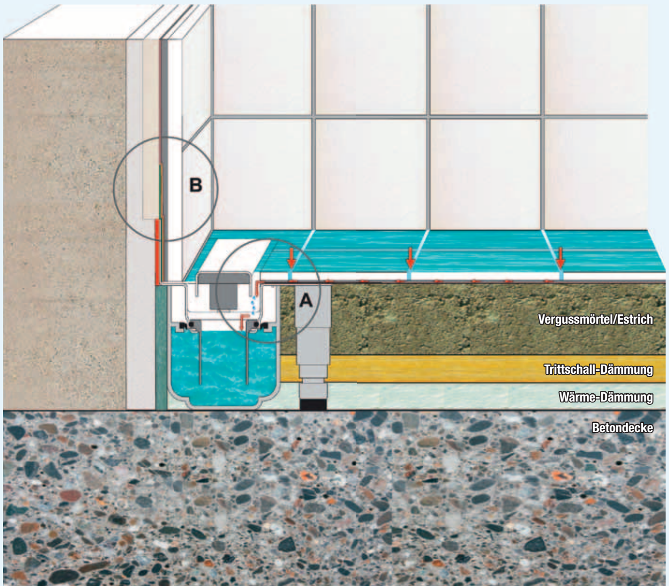
Anschluss Entwässerungsrinne Dallmer CeraLine Plan mit Sickerwasserablauf (Quelle: Dallmer GmbH & Co. KG)
