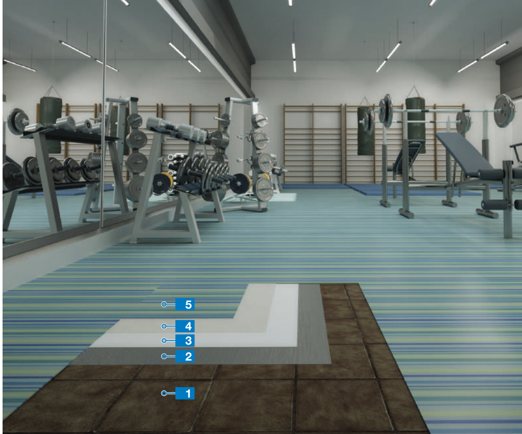
Aanbrengen van PVC op oude keramische tegels Pose de PVC sur d'anciens carrelages
