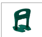
Afstandsclips MapeLevel ProWDG Spacer C Gekleurde afstandsclips in 7 diktes volgens de breedte van de voeg: 0,5 mm (oranje), 1 mm (groen), 1,5 mm (grijs), 2 mm (zwart), 3 mm (wit), 4 mm (geel) en 5 mm (rood). Voor tegels van 3 tot 12 mm dik.
