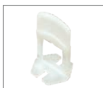
MapeLevel ProWDG Spacer C-H Gekleurde afstandsclips in 4 diktes volgens de breedte van de voeg: 1, 2, 3 en 5 mm. Voor tegels van 12 tot 20 mm dik
