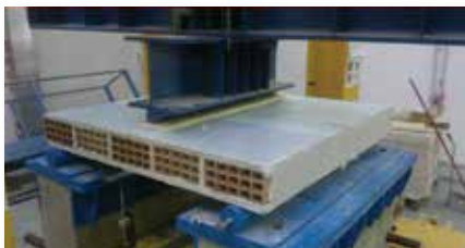
Δοκιμή σε κανονικού μεγέθους δάπεδο από τούβλα και τσιμέντο με ενίσχυση ΚΑΤΑ ΤΗΣ ΚΑΤΑΡΡΕΥΣΗΣ
