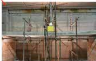
Δοκιμή σε κανονικού μεγέθους δάπεδο από τούβλα και τσιμέντο με ενίσχυση ΚΑΤΑ ΤΗΣ ΚΑΤΑΡΡΕΥΣΗΣ
