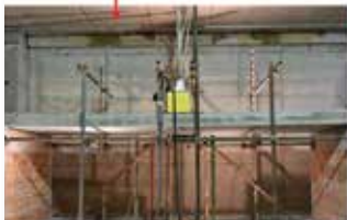
Δοκιμή σε κανονικού μεγέθους δάπεδο από τούβλα και τσιμέντο με ενίσχυση ΚΑΤΑ ΤΗΣ ΚΑΤΑΡΡΕΥΣΗΣ
