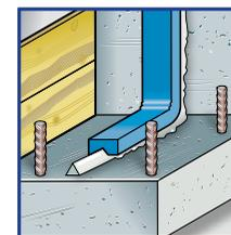
συγκόλληση υδρόφιλων διογκούμενων τεμαχίων σε αρμούς σκυροδέτησης
