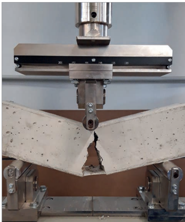
Immagine di laboratorio che evidenzia la capacità di fare ponte su fessure di Mapeproof FBT .
