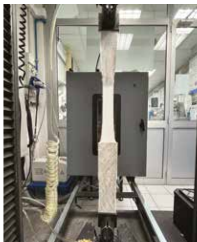
Laboratorio Mapei: test di shear in corrispondenza del SealLap.
