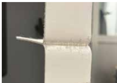
Laboratorio Mapei: test di peel in corrispondenza del SealLap.
