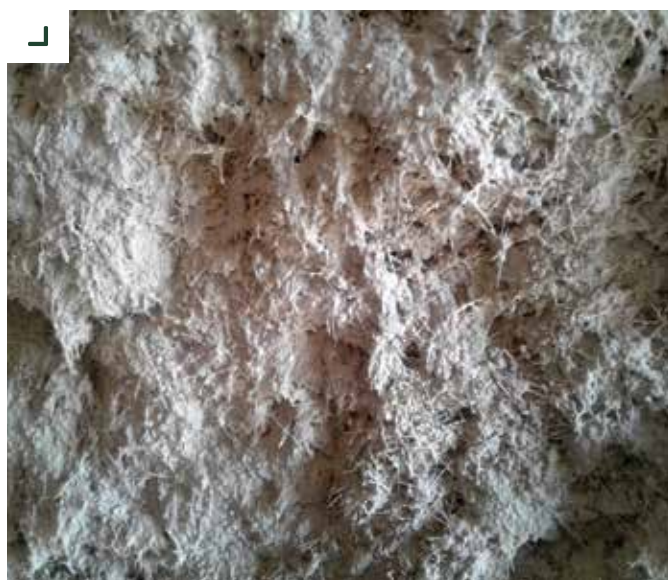
Dettaglio delle fibre in PLANITOP INTONACO ARMATO
