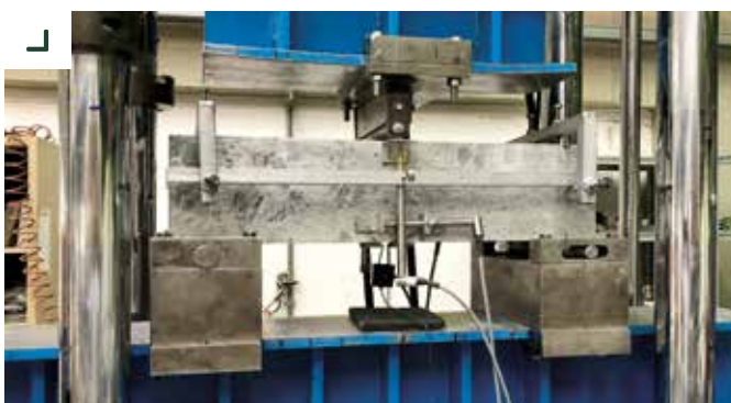
Risultati prove di resistenza a flessione residua secondo EN 14651
