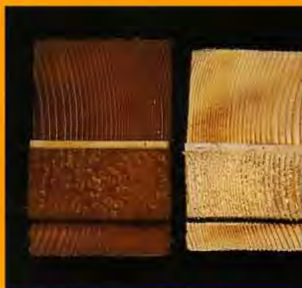
FIGURA 13 - Aspetto dei provini dopo le fasi di imbibizione (sinistra) ed essiccamento in stufa ventilata (destra). Le condizioni di invecchiamento accelerato, particolarmente severe, comportano lo sviluppo di forti tensioni all'interfaccia legno/adesivo.
