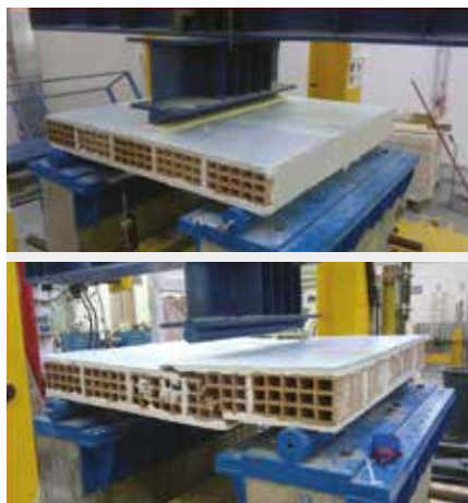
Test su tramezze in laterizio sottoposte a prove di flessione ortogonale con rinforzo per ANTIRIBALTAMENTO. Incremento della capacità deformativa sino al 500% senza perdita di capacità portante.
