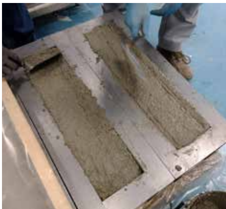
Esempi di alcune fasi consecutive di preparazione dei campioni per prove di flessione EN 14651
