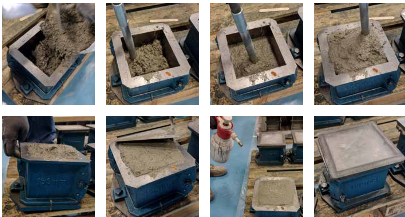
Esempi di alcune fasi consecutive di preparazione dei campioni per prove di compressione EN 12390-3
