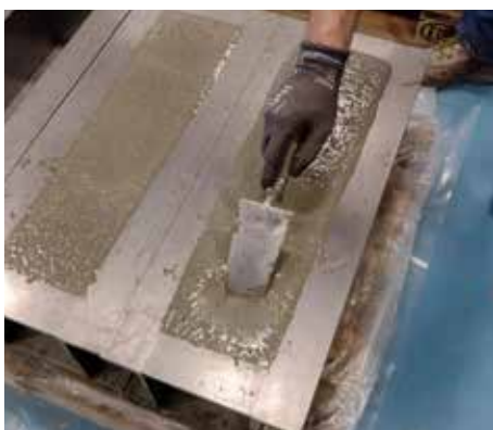
Esempi di alcune fasi consecutive di preparazione dei campioni per prove di flessione EN 14651
