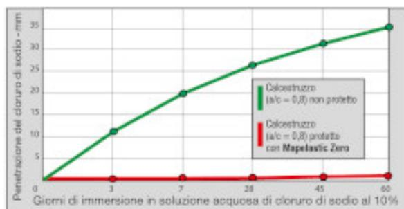
Fig. 3: Effetto **Mapelastec Zero** sulla penetrazione del cloruro di sodio in un calcestruzzo poroso
