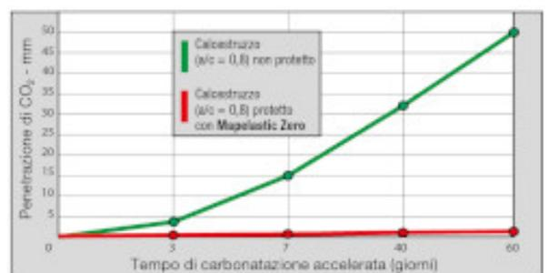
Fig. 2: Effetto di **Mapelastic Zero** sulla carbonatazione accelerata (30% di CO<sub>2</sub>) in un calcestruzzo poroso
