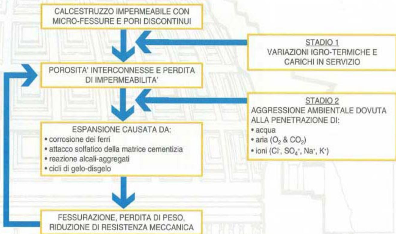
Fig.1 – Meccanismo di degrado secondo uno schema adattato da Mehta (1)
