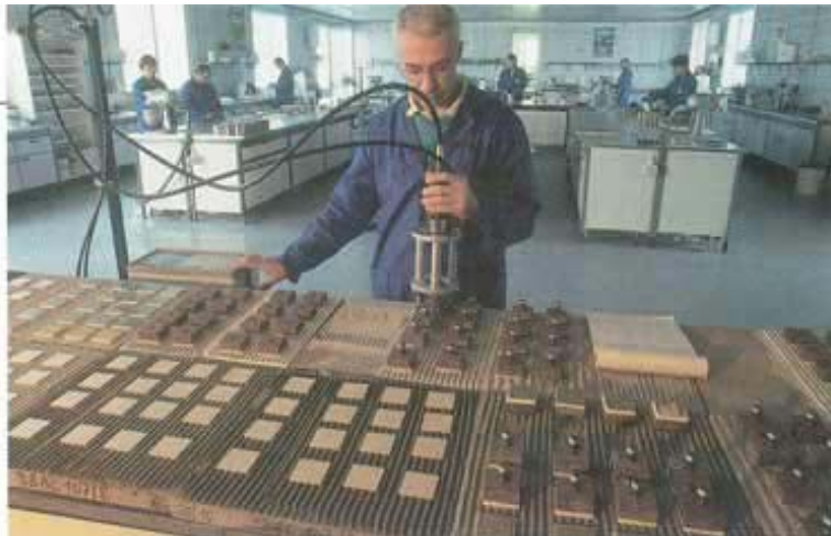
Due immagini del laboratorio di R&S di Milano, che occupa una superficie complessiva di 6.500 m 2 su un'area totale di 10.000 m 2 . A lato, prova di strappo su lastra cementizia nel laboratorio adesivi cementizi. Sotto, sala delle sintesi polimeriche (PVA, PU, Acrilici).
