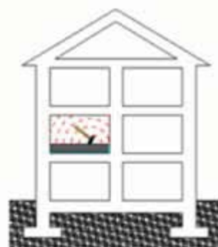
Figura 2. Il massetto galleggiante consente un migliore isolamento acustico.
