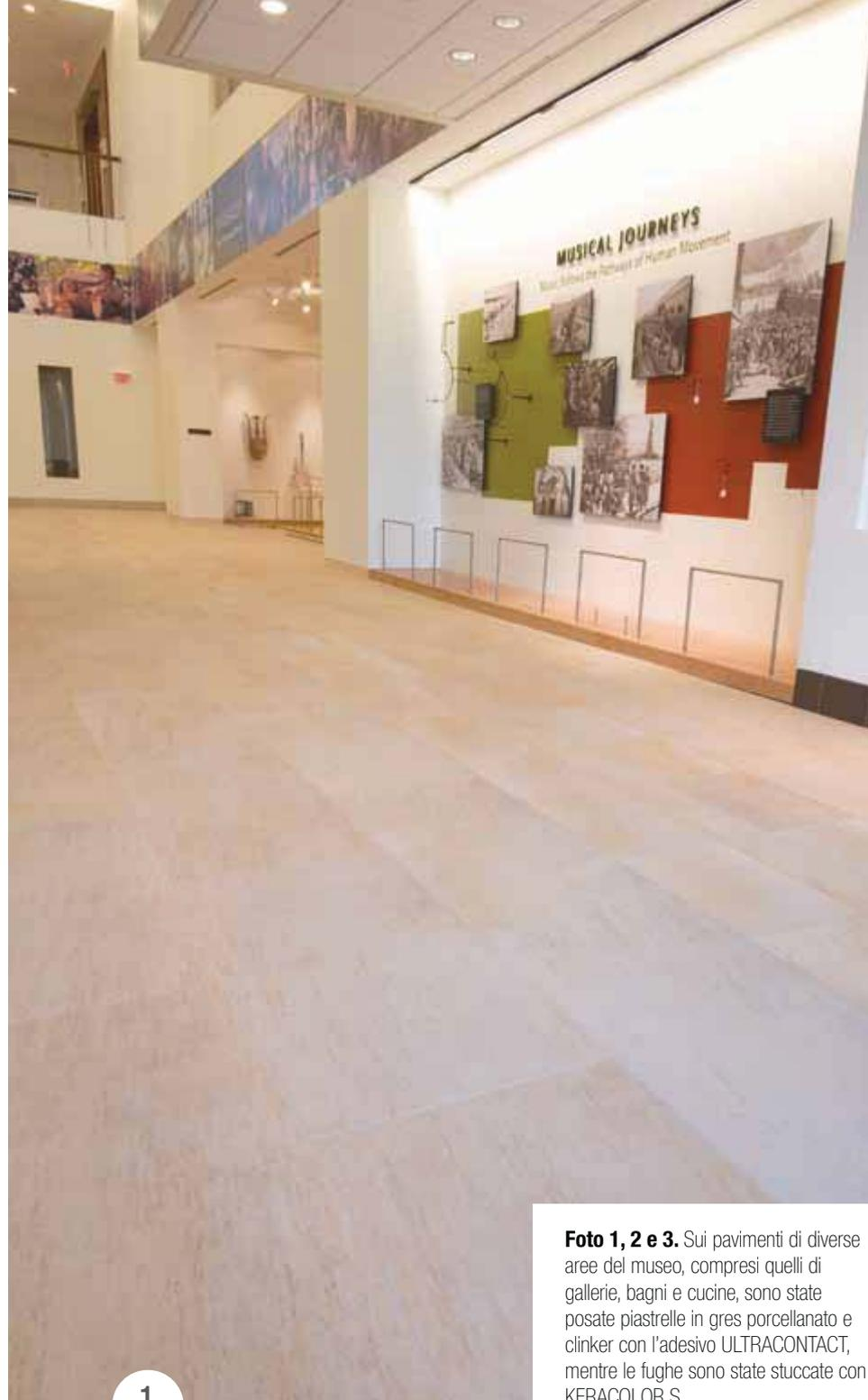
**Foto 1, 2 e 3.** Sui pavimenti di diverse aree del museo, compresi quelli di gallerie, bagni e cucine, sono state posate piastrelle in gres porcellanato e clinker con l'adesivo ULTRACONTACT, mentre le fughe sono state stuccate con KERACOLOR S.
