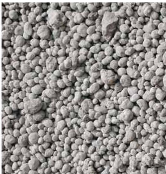
**Figura 4.** Granuli a matrice cementizia, frutto della trasformazione di materiali contaminati, attraverso la tecnologia HPSS.
