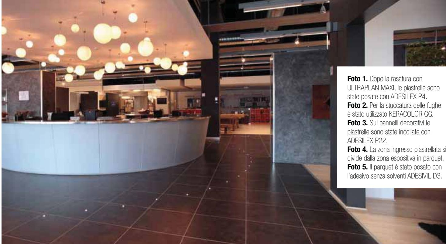
**Foto 1.** Dopo la rasatura con ULTRAPLAN MAXI, le piastrelle sono state posate con ADESILEX P4.
