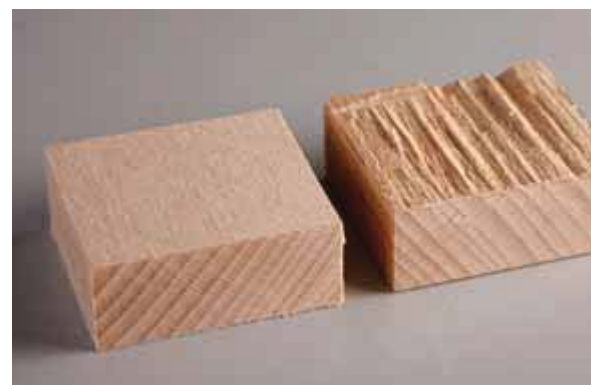
Fig. 2. Un provino nuovo e uno sfibrato mediante sforzo di taglio per compressione al dinamometro.
