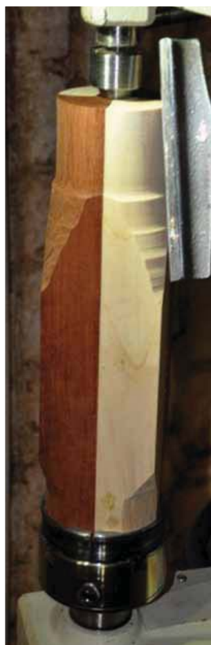
Fig. 1. Sagomatura al tornio di un macina-pepe ottenuto per incollaggio di due specie legnose.
