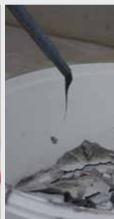
Eliminare le tre prime pompate di resina.
