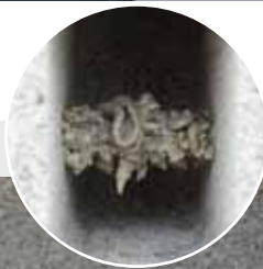
Diffusione della resina attraverso la bussola.
