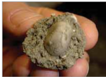
FIG. 1. Granulo di aggregato fresco prodotto con RE-CON ZERO.
