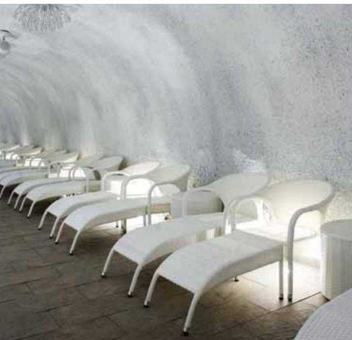
Le soluzioni Mapei per la posa dei pavimenti e dei rivestimenti sono state applicate con circa 5000 m<sup>2</sup> di superfici. Prima della posa, le superfici sono state livellate con PLANITOP FAST 330 e ADESILEX P4 e i preesistenti sottofondi cementizi sono stati consolidati con PROSFAS e primerizzati con PRIMER G.
