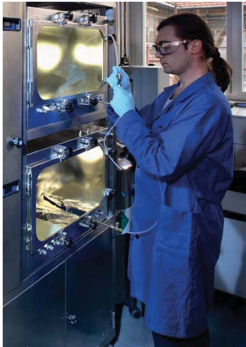
FIGURA 2. Il sistema di marcatura GEM EMICODE e la camera ambientale per la misura delle emissioni di VOC in ambiente "indoor" (Laboratorio R&D Mapei SpA).
