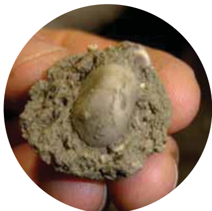
FIGURA 3. Esempio di produzione di un aggregato a partire dal calcestruzzo fresco non gettato (calcestruzzo reso) trattato con RE-CON ZERO®.
