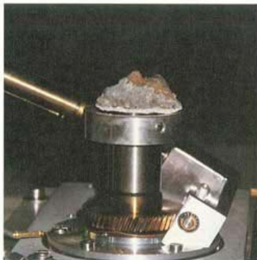
Sopra, il microscopio elettronico a scansione SEM: particolare della camera analitica, il campione ha un diametro di circa 3 cm
