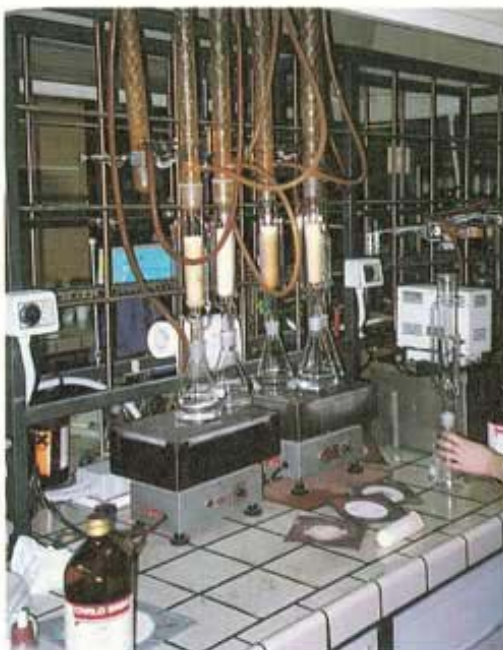
A lato, il laboratorio di analisi: particolare delle attrezzature per estrazione con solventi
