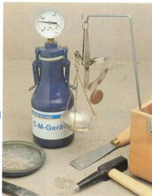
FOTO 2 Igrometro a carburo per misura assoluta di umidità.
