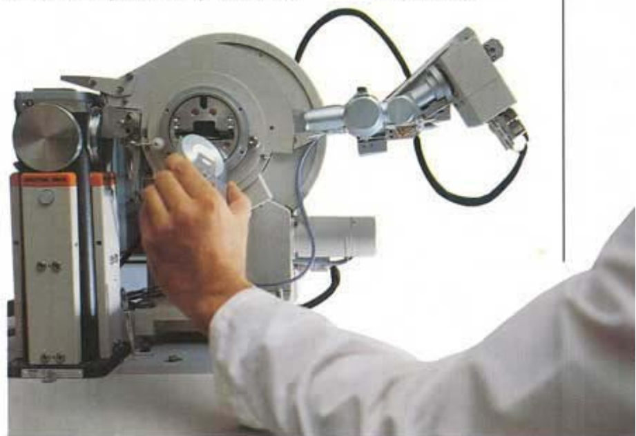
Diffrattometro a raggi X per l'analisi delle polveri. Qui è usato per verificare l'assenza di quarzo cristallino che è cancerogeno.
