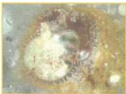
Particolare della malta con inclusione "argillosa". Nel suo interno ci sono strutture cristalline ben formate, alternate a zone di vetri
