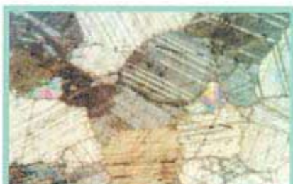
Foto in luce polarizzata di una superficie di Bianco Rosa: si evidenziano i granuli che compongono la matrice
