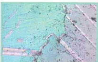
Particolare della foto precedente: la luce polarizzata evidenzia il differente orientamento dei granuli cristallini della pietra
