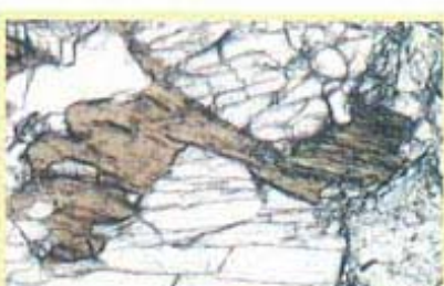
La struttura mista è qui evidenziata come alternanza di zone cristalline aventi composizione chimica differente
