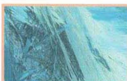
Particolare della struttura fibrosa presente nel marmo Verde Alpi
