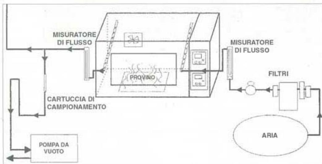
In basso: la camera ambientale perfezionata nel laboratorio di Milano; al centro lo schema del suo funzionamento
