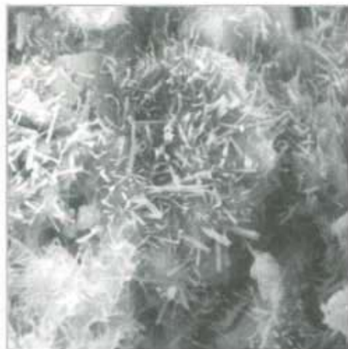
Fig. 1 Microstruttura di una pasta di cemento fotografata al microscopio elettronico a scansione.
