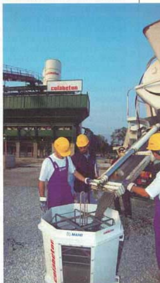
Fig. 2 - Test di cantiere per valutare l'autocompattabilità
