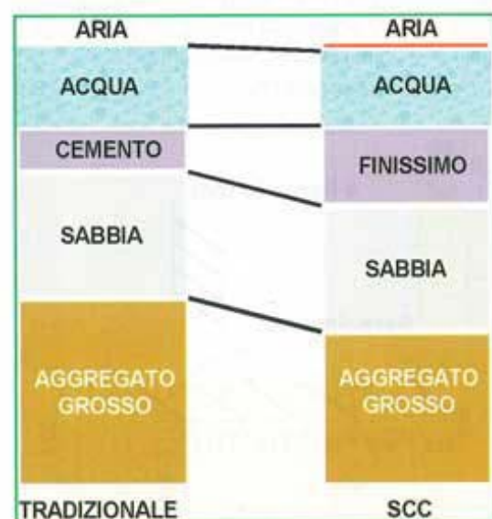
Fig. 6. Visione schematica delle differenze composizionali tra calcestruzzi tradizionali superfluidi e calcestruzzi autocompattanti.
