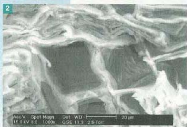
Fotografie realizzate al SEM su alcuni campioni di legno fossile nel Laboratorio R&S Mapei di Milano: 1. Sezione longitudinale del legno fossile nella zona corticale superiore; è ben visibile l'intreccio di microcanali tipico di strutture vegetali 2. Particolare della zona corticale; sono evidenti le cellule schiacciate in prossimità della corteccia 3. Sezione centrale del legno fossile; le cellule (esagonali) sono ben conservate, quasi come se il campione fosse ancora "fresco" 4. Particolare di una cellula del legno.
