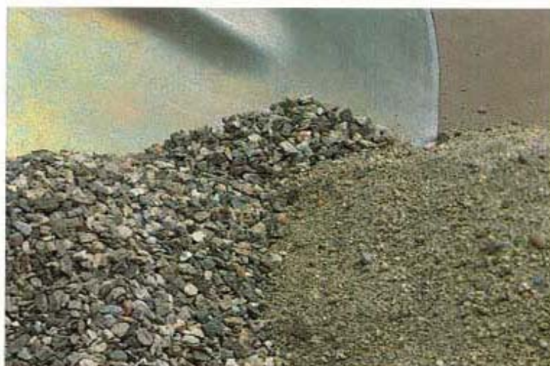
Dall'alto in basso, tre tipici inerti per malte disponibili in varie zone d'Italia; la sabbia 0-4 mm e il ghiaietto 4-8 mm da miscelare per malte di allettamento
