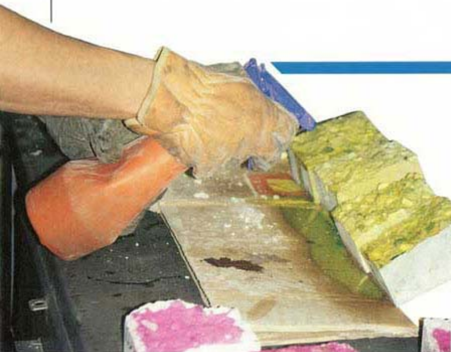
In questa pagina, prova di penetrazione dei cloruri e misurazione della profondità di carbonatazione
