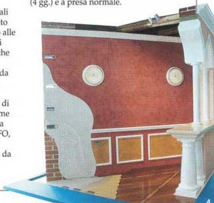
Per il livellamento del massetto si è usata la lisciatura autolivellante ad indurimento ultrarapido ULTRAPLAN. Il parquet è stato incollato con ULTRA/BOND P990 1K, un adesivo monocomponente poliuretano pronto all'uso elastico e senza solvente, adatto per tutti i tipi di parquet.
