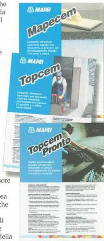
Visti la facilità di messa in opera, anche con pompa, la lavorabilità ed i tempi di presa non eccessivamente veloci, TOPCEM è particolarmente indicato per la realizzazione di caldane di elevata estensione superficiale, laddove si hanno a disposizione tempi ristretti per l'apertura al traffico della pavimentazione
