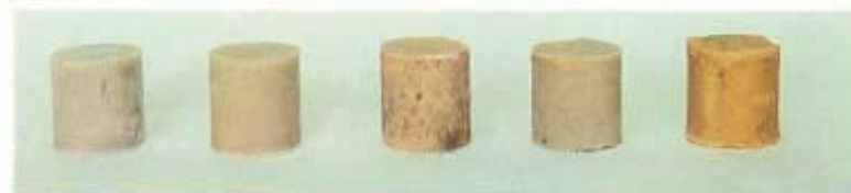
FOTO 3 Prove di resistenza di alcuni fuganti epossidici all'acido oleico in sospensione acquosa
