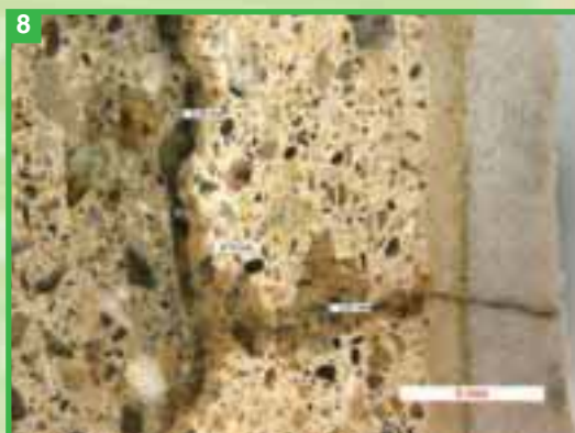
Foto 8. Sezione di un campione consolidato. Da destra a sinistra si trovano: le tessere, la "pastina", l'intonaco e il calcestruzzo di regolarizzazione.
