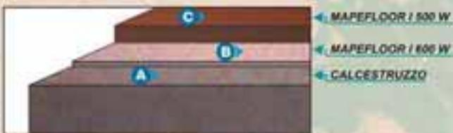
▲ MAPEFLOOR SYSTEM 53 - Sistema epossidico idrodisperso opaco autolivellante permeabile al vapore senza solventi per pavimentazioni fino a 4 mm di spessore, con aspetto finale liscio opaco. Indicato per pavimentazioni a traffico medio-pesante.
