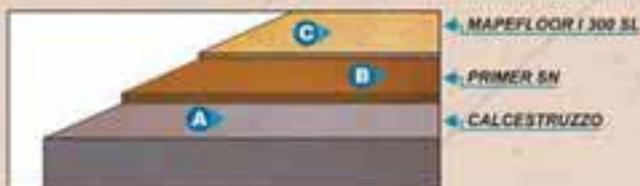
▲ MAPEFLOOR SYSTEM 31 - Sistema epossidico multistrato senza solventi per pavimentazioni da 0,8 a 1,2 mm di spessore, con effetto antisdrucciolo. Indicato per pavimentazioni a traffico medio-leggero. Prodotti da utilizzare: PRIMER SN, MAPEFLOOR I 300 SL, QUARZO 0,5, QUARZO 0,25.
