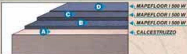
▲ MAPEFLOOR SYSTEM 52 - Sistema epossidico idrodisperso opaco multistrato permeabile al vapore senza solventi per pavimentazioni da 5 mm di spessore, con aspetto finale antisdrucchiolo opaco. Indicato per pavimentazioni a traffico pesante.
