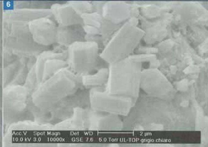
Figura 4. Cristalli di ettringite di sintesi.
