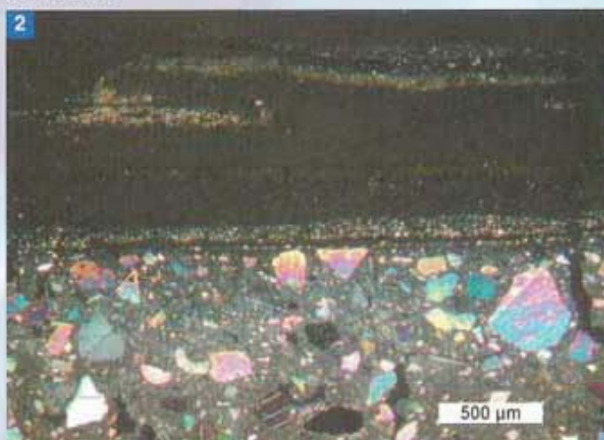
sottostante vista a 2N: il limite tra marmorino e intonaco è segnato anche dalla variazione della natura degli aggregati, che sono per lo più carbonatici (calcitici) nel marmorino e silicatici (con quarzo e feldspati) nell'intonaco.
