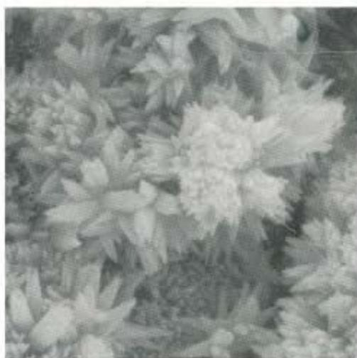
*Cristalli di ettringite (foto realizzata nel laboratorio Mapei con microscopio elettronico SEM XL20 Philips - 8.000 ingrandimenti).*
