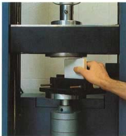
Sopra, determinazione della flessibilità e deformabilità dell'adesivo descritta a pagina 18.
