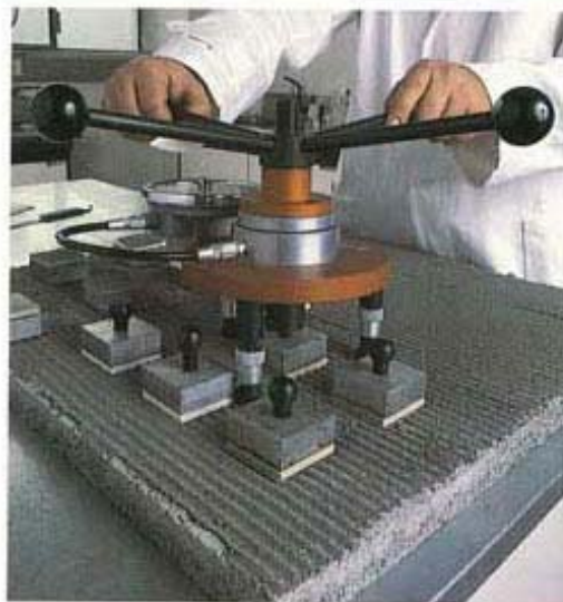
A destra, metodo di prova dell'adesione per gli adesivi cementizi: Pull test
