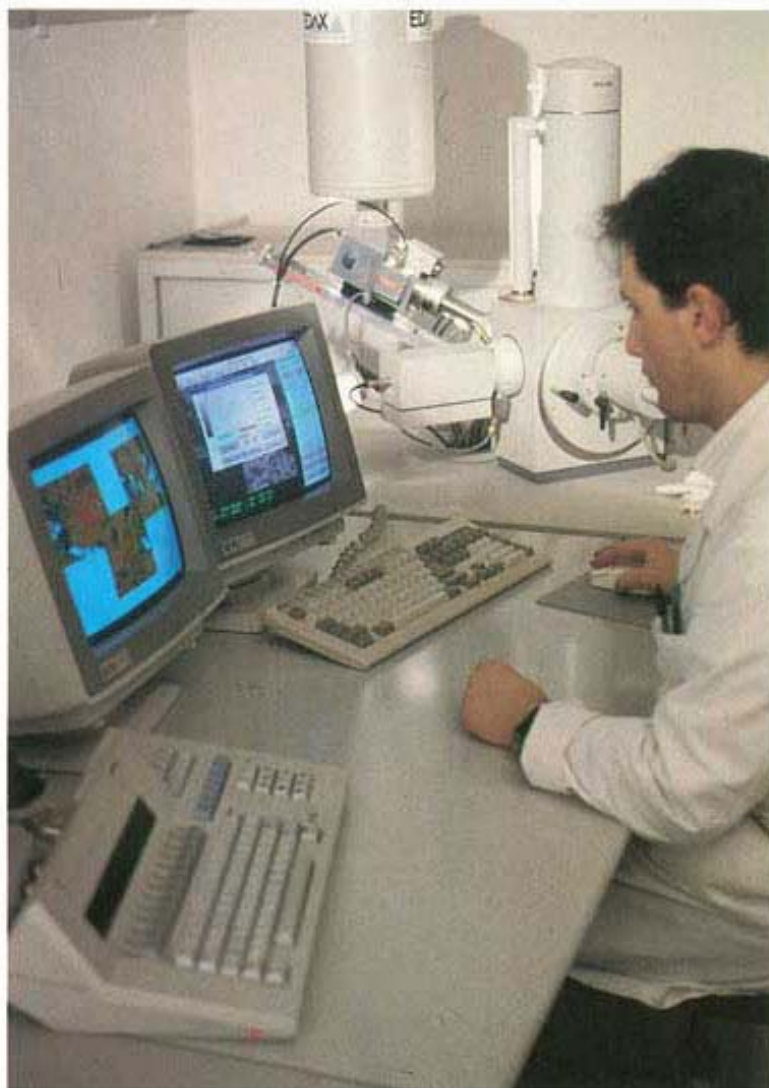
Nella foto un momento degli studi con il microscopio elettronico Philips XL20 (SEM) che permette di eseguire analisi morfologiche molto sofisticate sugli aggregati utilizzati nelle malte.
