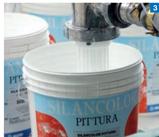
Foto 6. Verifica del colore e prelievo archivio per collaudo.
