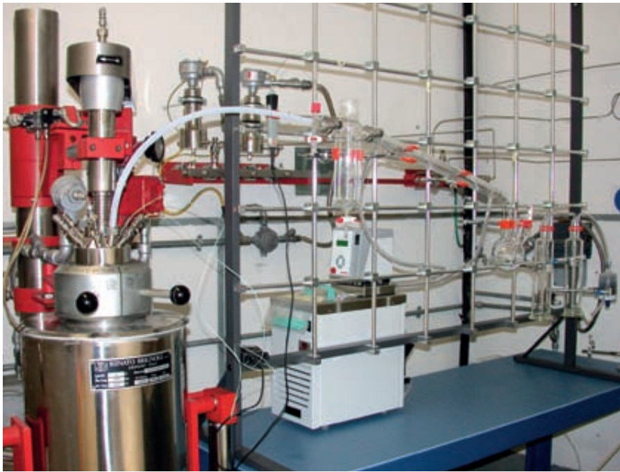
Immagine dell'impianto pilota di laboratorio per lo studio della fase di distillazione estrattiva del sistema MAPEI HPSS.
