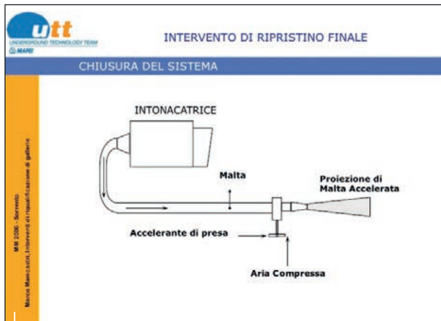
Foto 1. Schema del sistema di posa adottato.
