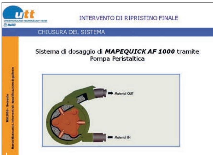
Foto 2. Schema di una pompa peristaltica.
