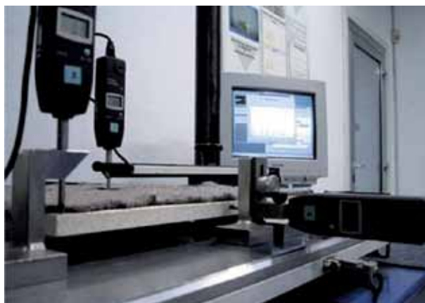
Lo strumento utilizzato per la prova di stabilità dimensionale delle lastre.
