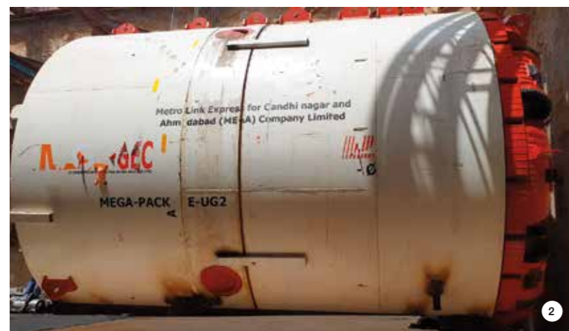
1. Vista interna di uno dei tunnel scavati con soluzioni Mapei per lavori in sotterraneo come POLYFOAMER FP, POLYFOAMER FLS, MAPEDISP FLS e MAPEBLOX T. 2. La fresa meccanica di tipo TBM-EPBM utilizzata durante i lavori di scavo delle gallerie.
