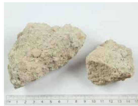
I campioni di malta prelevati dalla muratura esistente sono stati analizzati nei Laboratori Mapei per indagarne granulometria e composizione mineralogica.
