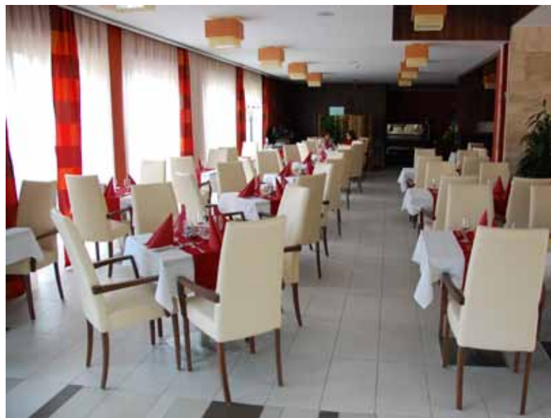
Az étterem greslap burkolatát KERAFLEX ragasztóágyba fektették. Fugahézagokat KERACOLOR FF FLEX fugázóhabarccsal töltötték ki.
