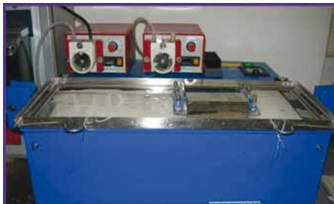
Moshatósági teszt a MAPEI-laboratóriumában növekvő PVC érték esetén
