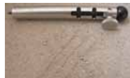
Karccpróba. A burkolat nem kerülhet gyenge, porló, morzsolódó aljzatra.
