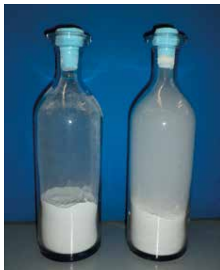
L'immagine riporta due barattoli agitati da pochi secondi, contenenti a sinistra un adesivo LOW DUST e a destra un adesivo tradizionale
