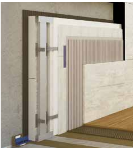
Rasatura e posa su pannelli in fibrocemento
