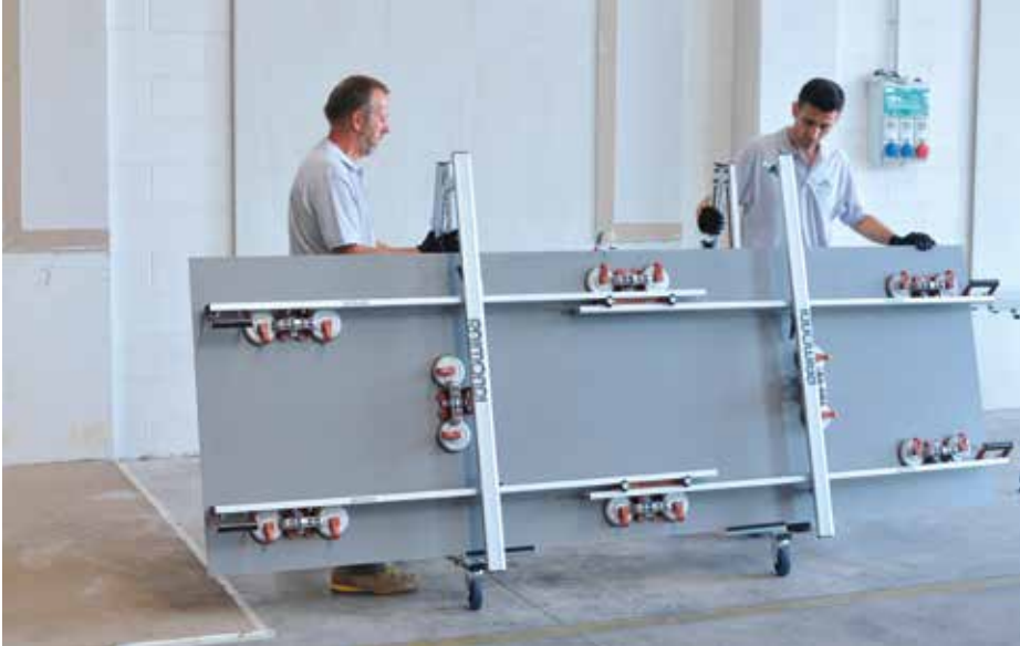
Movimentazione di lastre sottili mediante l'utilizzo di specifici strumenti dotati di ventose
