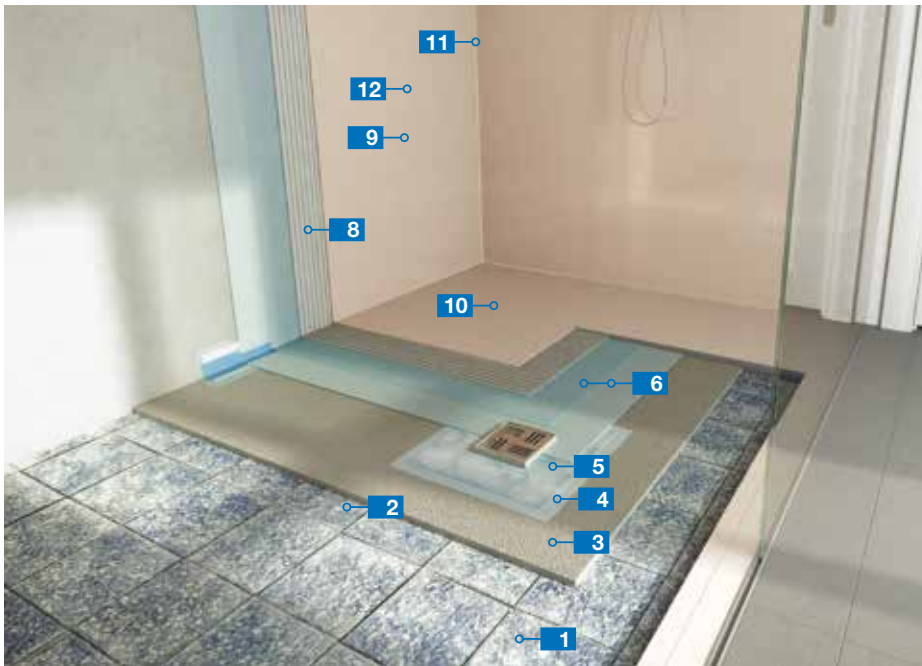
Rifacimento di bagni con sistema di impermeabilizzazione e posa di mosaico vetroso
