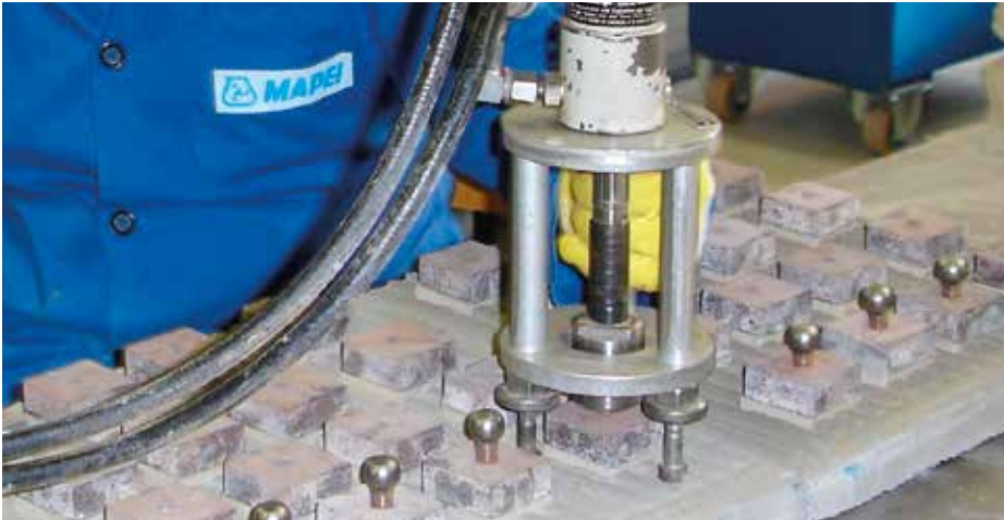
Prove di pull out per adesivi
