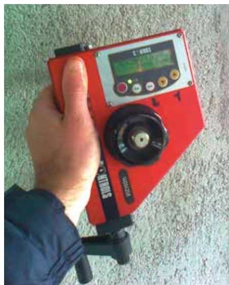
Valutazione dell'intonaco in base al risultato del test di pull-off
